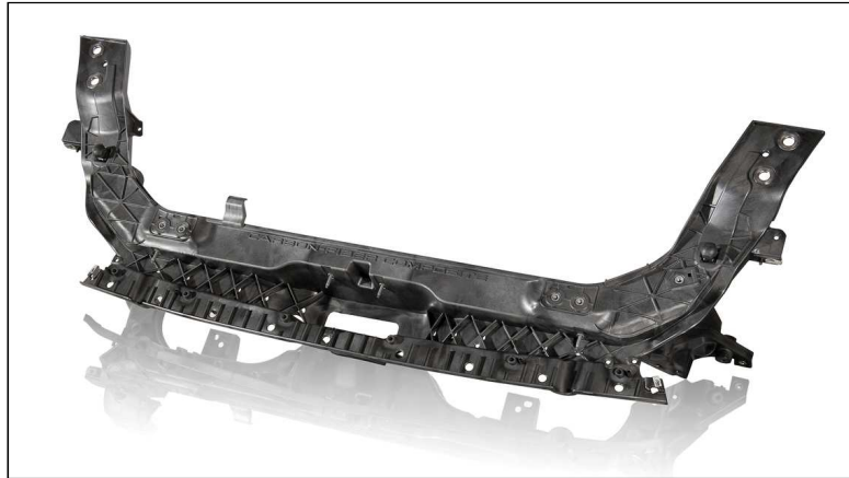
6. ábra Gépkocsi hátsó tengelyének kereszttartója először műanyagból gyártva [ Ultramid A3WG10 CR (BASF) ]
