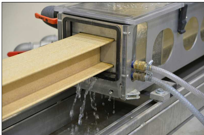
1. ábra H-profil extrudálása 72% farostot és 28% PP-t tartalmazó WPC-ből
