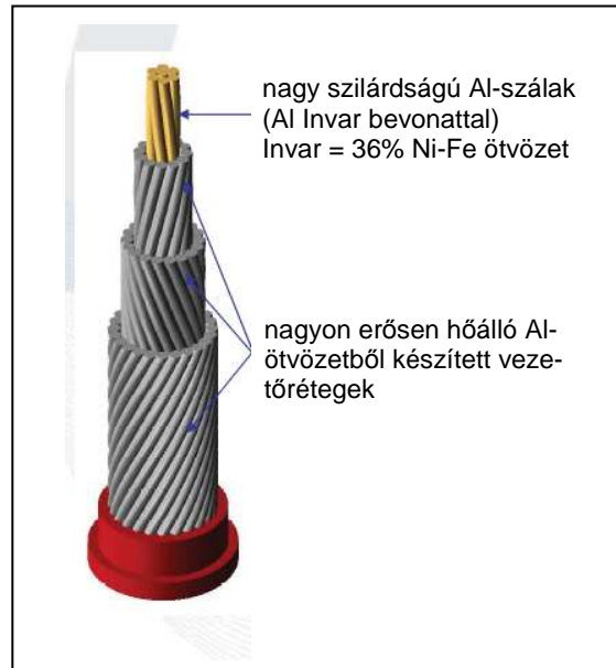
9. ábra Egy tipikus HTLS kábel vezetője
