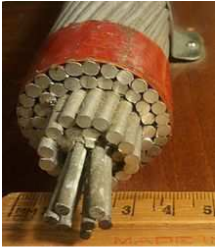
8. ábra Egy ASCR kábel vezetője, hét acél-szállal és ezeket négy rétegben körülvevő alumíniumszálakkal
