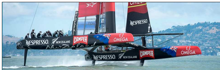
3. ábra A North Thin Ply szénszálas UD-prepregjéből épített versenyhajók
