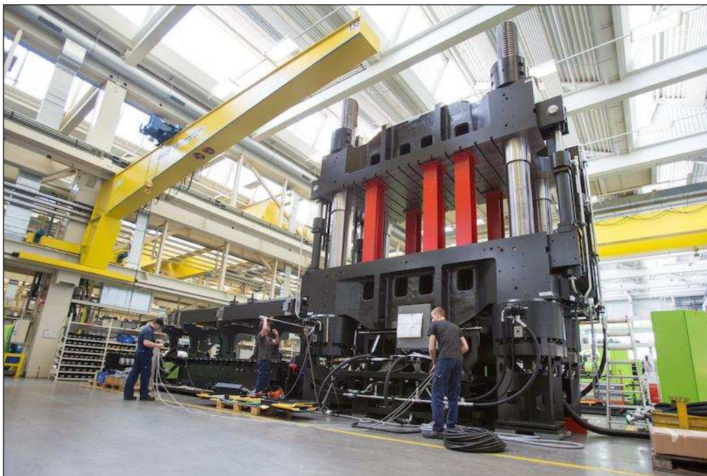
2. ábra Az Engel v-duo 3600 jelzésű fröccsgépe szerelés közben
