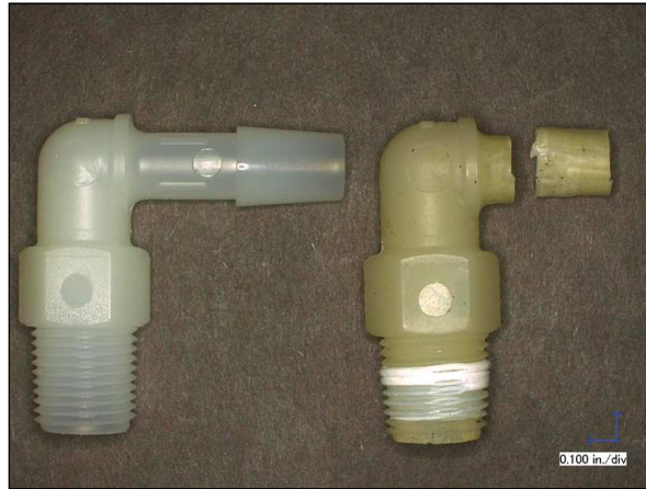
1. ábra Ezt a PA könyököt hat hónaponként kellett cserélni törés miatt
