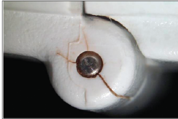
3. ábra A betegeknek kiadott törött fedelű orvosi ellenőrző készülék
