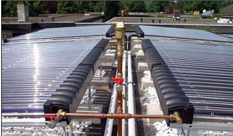
4. ábra A szabadtéri kísérleti állomáson összeállított kollektorrendszer
