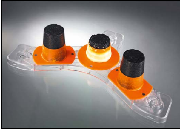
2. ábra Az ütközési próbákhoz alkalmazott próbatesttartó a fröccsöntött sapkákkal fedett próbatestekkel. A középső, sapka nélküli próbatest az ütközéskor széttört
