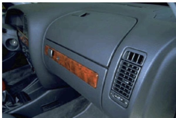
1. ábra PVC öntőporkeverékből (slush powder) készített műszerfal
