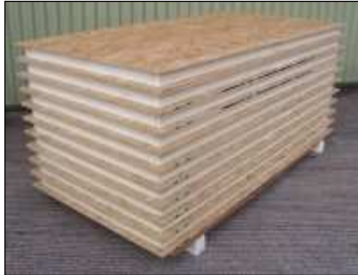
2. ábra Felhasználásra előkészített SIP lemezek, amelyekbe két OSB lap közé PS hablemezt ragasztanak
