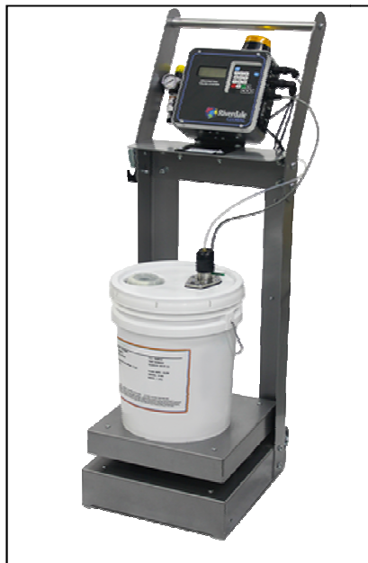
1. ábra A Riverdale Global cégnél alkalmazott és a Magure Productsnál kifejlesztett zárt adagolórendszer a folyékony segédanyagok adagolására és bevitelére a műanyagfeldolgozó gépbe
