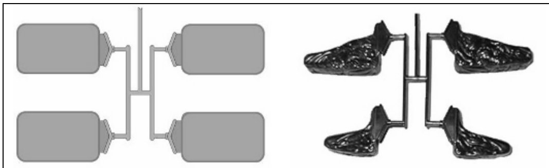
4. ábra Egy 19 mm falvastagságú termék négyfészkés gyártószerszáma (bal oldali kép) és a folyási kép részleges kitöltés után
