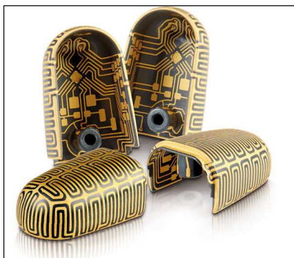
3. ábra Fröccsöntött ipari robot ujjja a felületén kialakított (MID) vezetőképes rétegekkel összekötött villamos alkatrészekkel. A lézersugár nemcsak háromdimenziós alakkövetésre képes, de a fal áttöréseinél is kialakítja a vezetőképeséget
