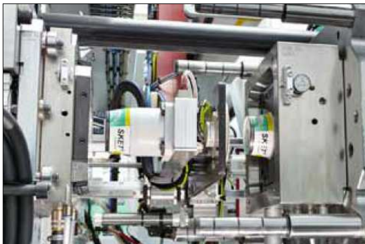
5. ábra A 2014-es Fakuma kiállításon bemutatott kísérleti gyártóberendezés Sket joghurtos poharakat készít. A képen a nyitott fröccsszerszám látható
