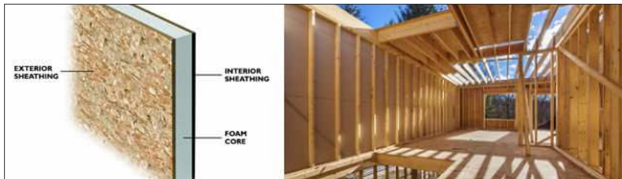
3. ábra Thermocore SIPs hőszigetelt lemez
