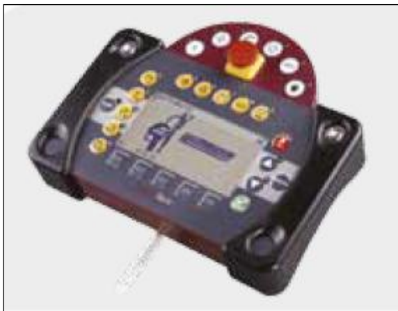
5. ábra Egy robotokat „betanító” eszköz
