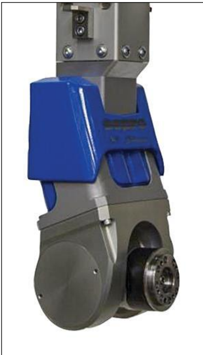
3. ábra A Sepro cég 5X Line típusú robotjain alkalmazott szervocsukló
