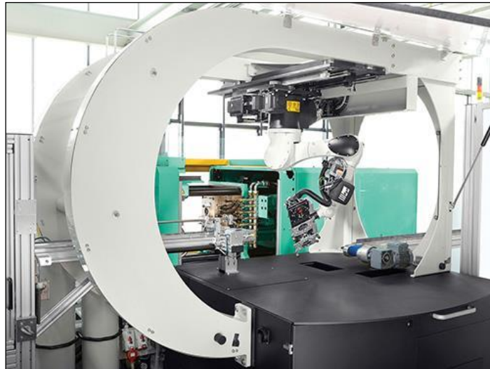
7. ábra Az Arburg cég gyártóberendezése a fröccsgép melletti gerendára felfüggesztett Kuka gyártmányú hattengelyes Agilus robottal
